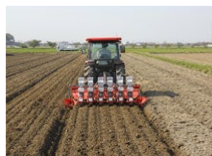
幅 3 m 以内の排水溝の設置（は種時）
