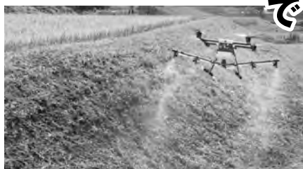
のり面に抑草剤を散布するドローン
