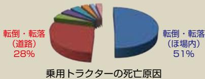
平成26年に発生した農作業死亡事故のうち、乗用トラクターによる死亡事故が27%を占めています。そのうち、8割近くが、ほ場や道路からの転倒・転落によるものです。
